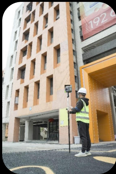
Csatlakozás a hálózati vagy URH korrekcióhoz
