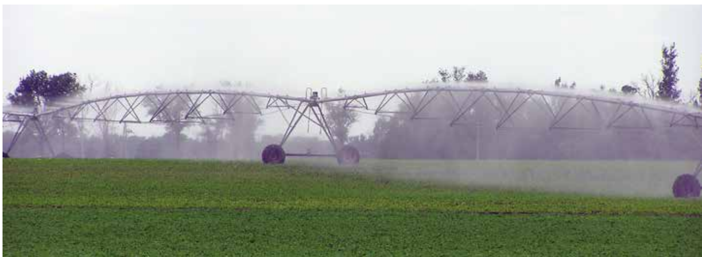
Járótornyokon helyezkednek el a hajtásért felelős elemek: a villanymotor, a kerékajtóművek, a kerek, a kardán
