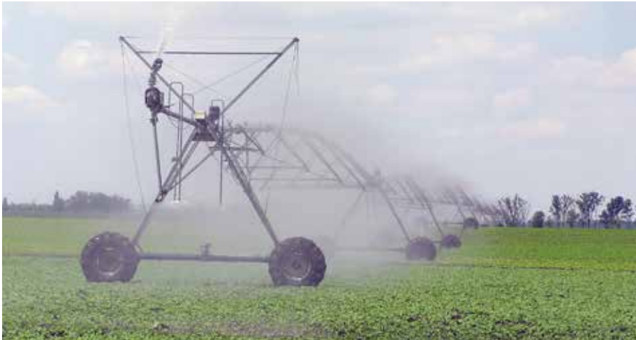
A haladási sebesség 0-120 m/óra között fokozatmentesen állítható. A kijuttatható vízáradék 5-50 mm
