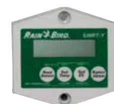
Talajnedvesség-vezérlő – A mért víztartalom alapján a vezérlő folyamatosan kapcsolja a szelepeket a beállított érték eléréséig
