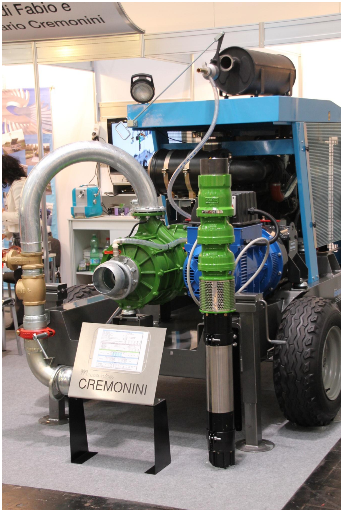
valamint a felszíni- és búvárszivattyút egyaránt tartalmazó dízelmotoros egység.
